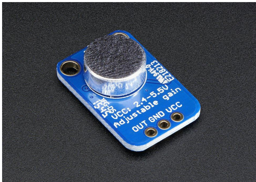
Slika 2.4 kondenzatorski mikrofon s pojačalom [2]
