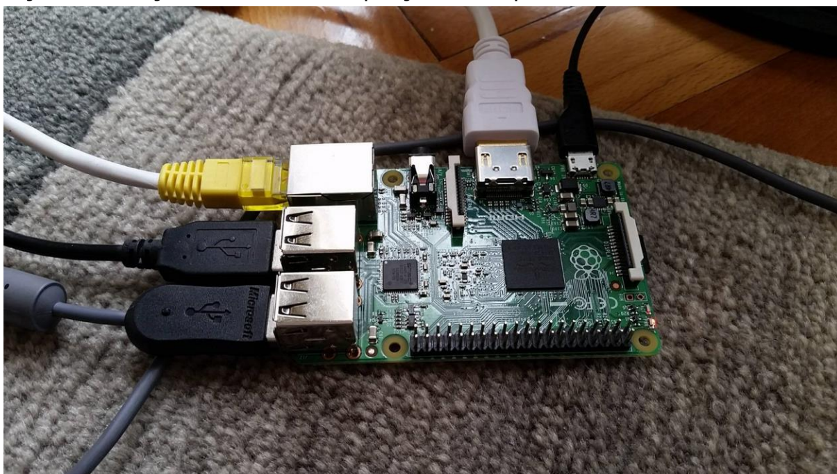
Slika 3. Raspberry Pi sa spojenom periferijom i napajanjem
