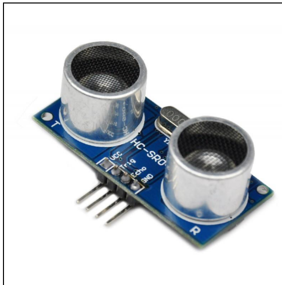
Slika 3. HC-SR-04 ultrazvučni senzor - sonar
