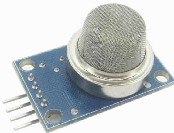
**Slika 7: MQ2 senzor**
