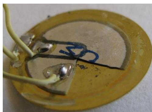
Slika 10: Piezoelektrični disk
