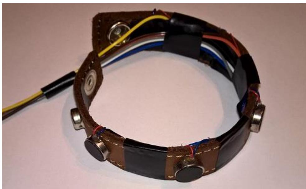
**Slika 5: Narukvica s vibracijskim motorićima**
